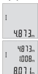
За измерване натиснете краткотрайно бутона за измерване **2 [▲]**. Измерената стойност се изобразява в долната част на дисплея.
